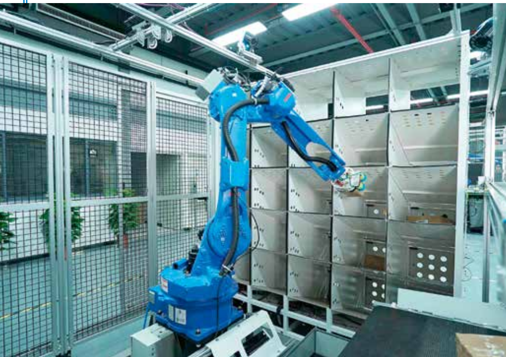
Dorobot манипулятор - укладка товаров по ячейкам
